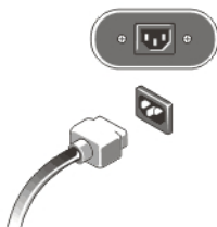
Figura 8. Conectarea la sursa de alimentare
